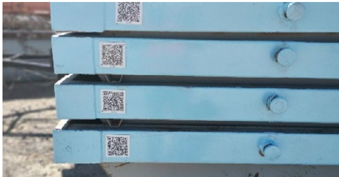
Volquetes con código QR para georreferenciación
